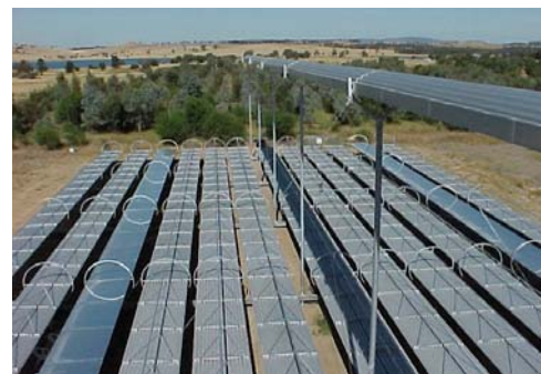
Grafische Simulation eines Fresnel-Kollektors (links) und Foto eines Testkollektors in Australien (rechts; Quelle: SHP, Mühlheim/Ruhr).
